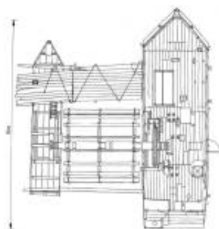
6. ábra. Az uszódi (Pest-Pilis-Solt-Kiskun m.) hajómalom felmérési rajza
